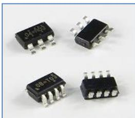
成本最低的封装中，TSOT23-6 和 SOT23-8 都是很好的选择。6 脚的封装对基本降压转换器而言是够用的，而 8 脚的封装则可提供如软启动或 PGOOD 等额外的功能。这些封装没有散热焊盘，所以大部分 IC 的散热就是透过封装接脚而到 PCB 的铜线。
